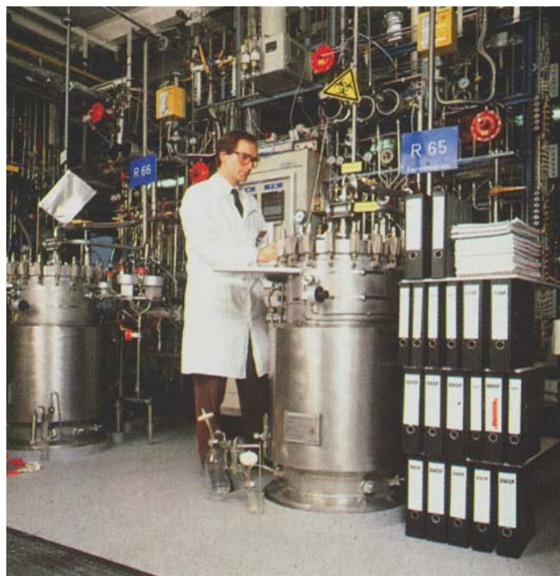
Abb. 15. Die in der Genehmigungsphase befindliche Produktionsanlage für TNF hat ein Fermentationsvolumen von 200 L. Die Jahresproduktion soll 0.5 kg betragen. Sie wird in einem bestehenden Gebäude errichtet und nutzt vorhandene Infrastruktur. Im Bild der Fermenter, daneben die Unterlagen, die für die Herstellungsgenehmigung erstellt wurden.
